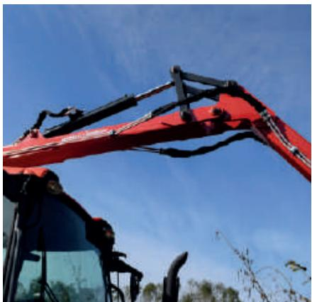
*Carico rapido e preciso con il sistema a parallelogramma*
