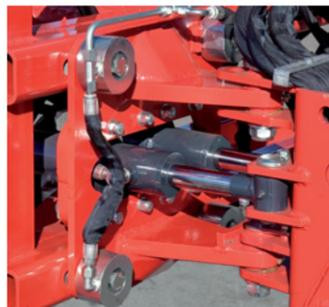
Bloccaggio idraulico traslazione
